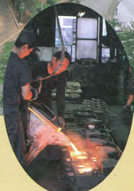
鋳型に湯(鋳鉄を溶解したもの)を流し込む風景
